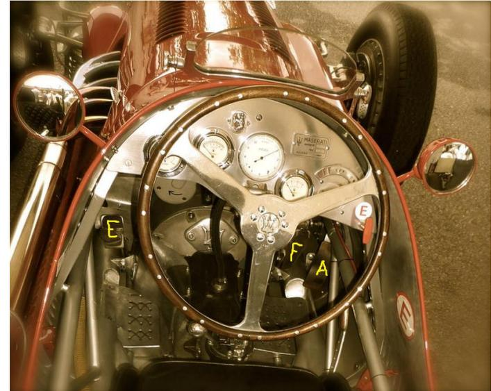
Du coup la pédale d'Embrayage est très loin de celles de Frein et d'Accélérateur ! Notez ci-dessous la complexité des éléments de suspension et de direction, la commande hydraulique des freins et les prises d'air de refroidissement des tambours avec le petit grillage pour qu'un gravier n'aille pas les gripper. Les freins à tambours perdurèrent en course jusqu'à la fin des années 50, mais il s'agissait de tambours très évolués traversés
