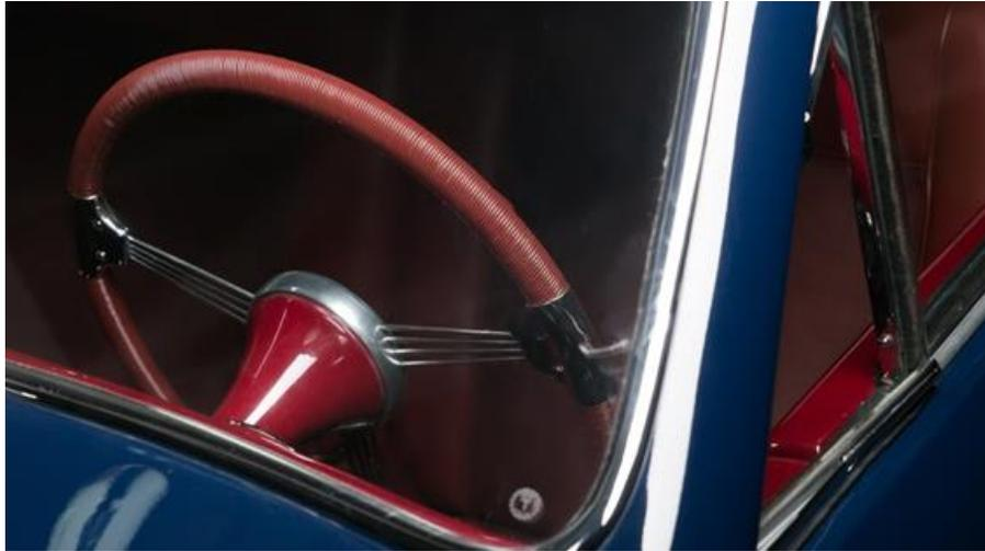
*Certains modèles de volant, à rayons en aluminium, bénéficiaient sur la jante d'un cordage synthétique antidérapant et antitranspirant .*
