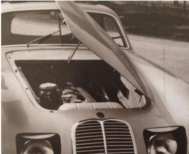
*le capot pouvait s'ouvrir comme on le voulait, vers la gauche ou vers la droite. On pouvait même le déposer en un tour de main. On voit bien le 6 cylindres en ligne à un seul carburateur (admission à droite comme sur toutes les Maserati à moteur en ligne sauf la Birdcage). Noter le pare-brise en deux pans.*
