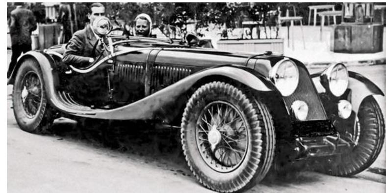
Le prototype A6 1500 GT ne fut cependant pas la première Maserati atmosphérique car deux barquettes de course réalisées l'une en 1945 (6 CS) et l'autre en 1946 (6 CS 46) disposèrent du moteur 6 cylindres en ligne, 1.5 litres, 2 arbres à cames en tête de la 6 CM d'avant guerre mais dépourvu de compresseur pour répondre à la nouvelle réglementation de la catégorie "Sport". Voici l'exemplaire unique 6 CS de 1945, la toute première Maserati atmosphérique :
