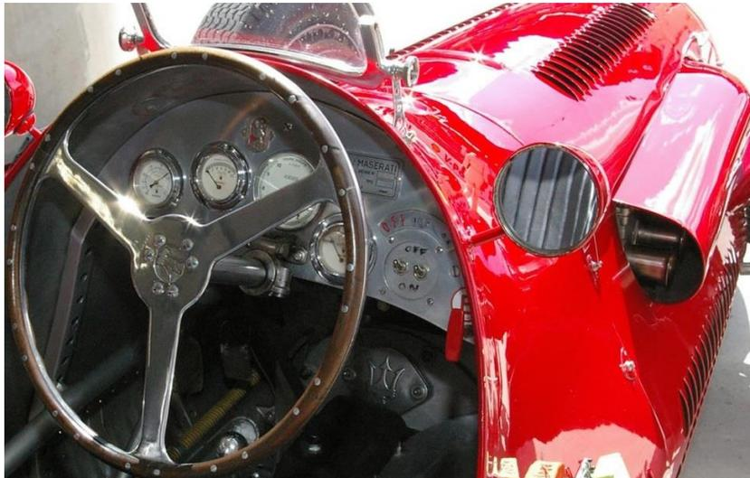
La "bosse des carburateurs" est ouverte vers l'arrière sur l'A6GCM. L'idée était que les carburateurs n'aient pas trop chaud pour concevoir un mélange plus frais moins sensible au cliquetis. Sur les 250 F à partir de 1956, la "bosse des carburateurs" sera ouverte vers l'avant pour assurer une petite surpression par la vitesse de l'air admis.
