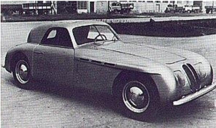
Mais revenons en 1946 avec notre prototype Pinin Farina. Le moteur de l'A6 1500 GT (alésage, course = 66, 72.5) , bien que possédant aussi 6 cylindres en ligne et "cubant" également 1.5 litres atmosphériques, était totalement différent du moteur ex-6 CM des barquettes 6 CS et 6 CS/46 à la course plus longue (65,75).
