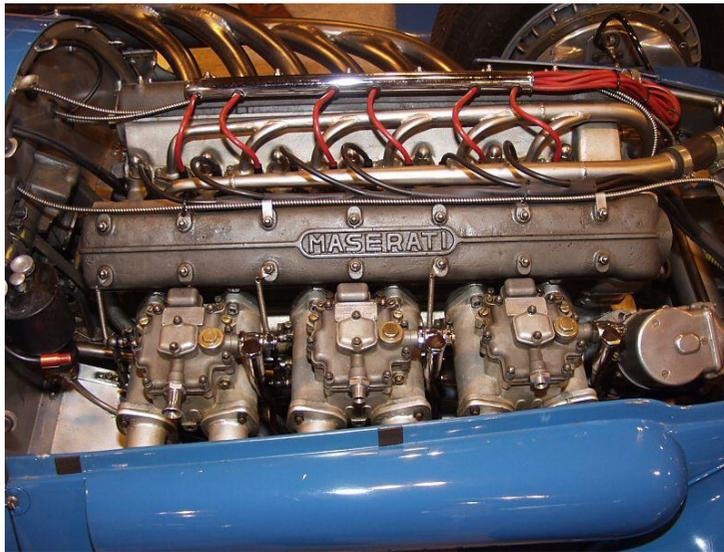
*Le 2.5 litres de 240 cv tient sans problème dans la coque A6GCM avec ses (84, 75) contre (76.2 ,72) au 2 litres "interim" de 197 cv. Le moteur 2.5 litres gardera les "linguette" jusqu'en 1957. Les carburateurs Weber sont désormais des 42 DCO3 au lieu des 40 DCO3 de la 2 litres.*
