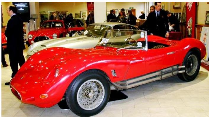
*2123 fut accidentée en Allemagne en 1959 et réparée la même année aux ateliers Zagato à Milan. Elle reçut cette carrosserie "spider" unique à phares carénés qui laissait apparentes les deux lignes d'échappement superposées sur la gauche, comme sur les A6GCS/53 "spider Fantuzzi".*
