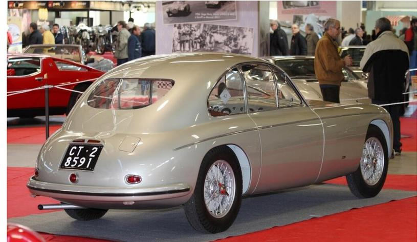
**Pas d'ouverture de la malle pour le "Panaromica Zagato", on glissait les bagages vers l'arrière par l'habitacle ! Ci-dessous une malle d'A6 1500 GT "de base" avec un accès par coffre ouvrant mais un encombrement par la roue de secours et le bouchon de remplissage d'essence .**
